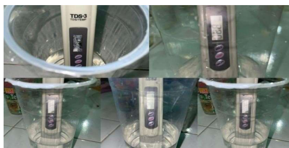
Gambar 3. Pengukuran TDS (Sumber: Dokumentasi Peneliti)
